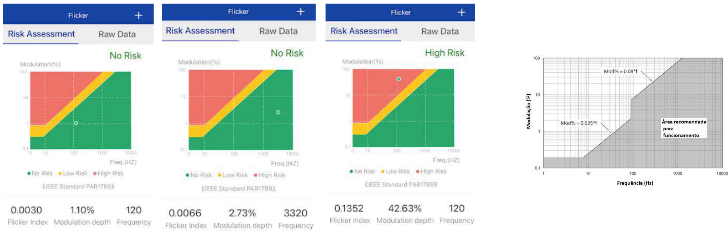
Figura - A indicação de resultados de medições (ponto no plano IEEE 1789-2015) em 14/set./2023, à direita com frequência 120 Hz e classificada "risco elevado" devido ao nível de modulação ser elevado (ver outras duas amostragens, à esquerda).
