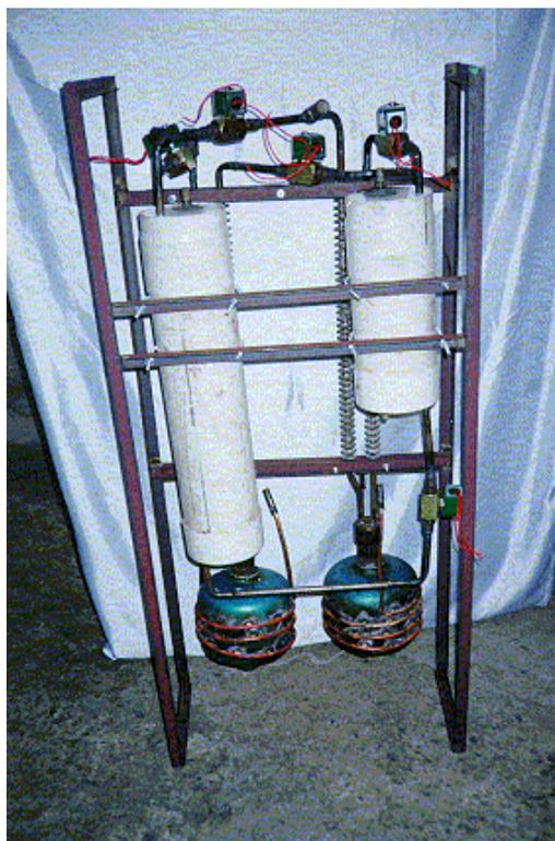
Figura 3.8 – Vista do sistema de válvulas solenóide.
