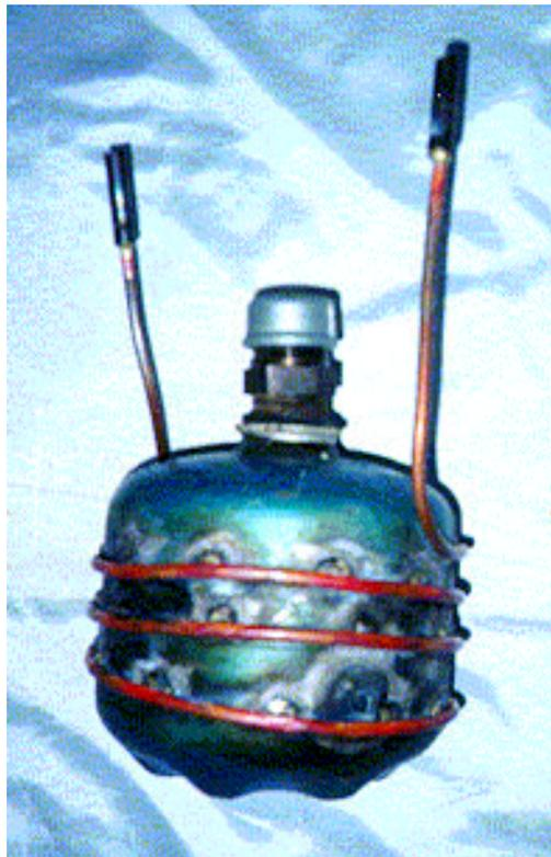
Figura 3.6 -Foto do gerador-absorvedor (segundo protótipo)
