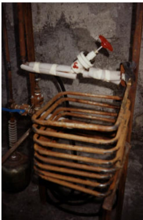
Figura 3.3 – Detalhe da tubulação do evaporador do primeiro protótipo.
