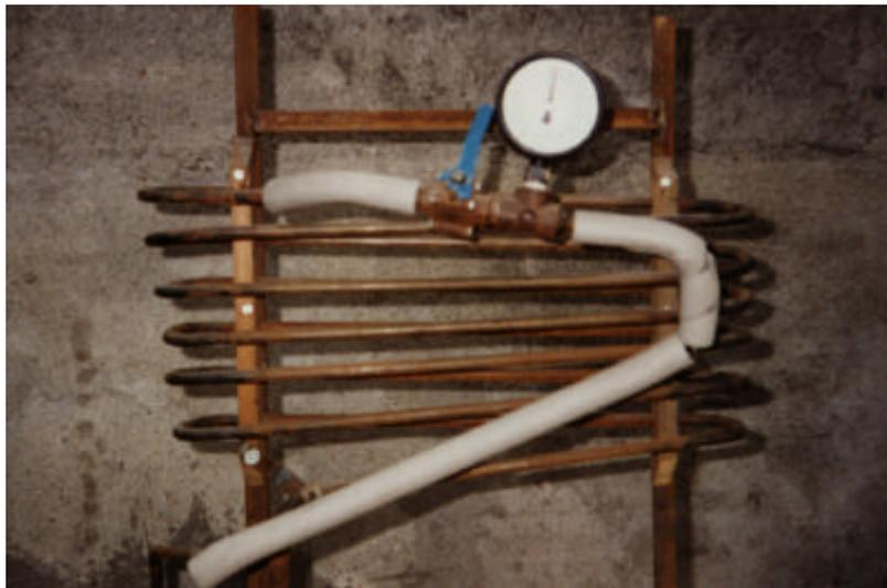
Figura 3.2 – Detalhe do condensador do primeiro protótipo.
