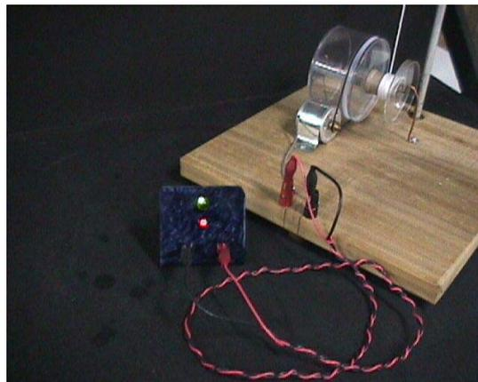
Foto 3.4 A garrafa suspensa, quando desce, faz o motor/gerador girar, gerando energia elétrica que acende o *led* (diodo emissor de luz)
