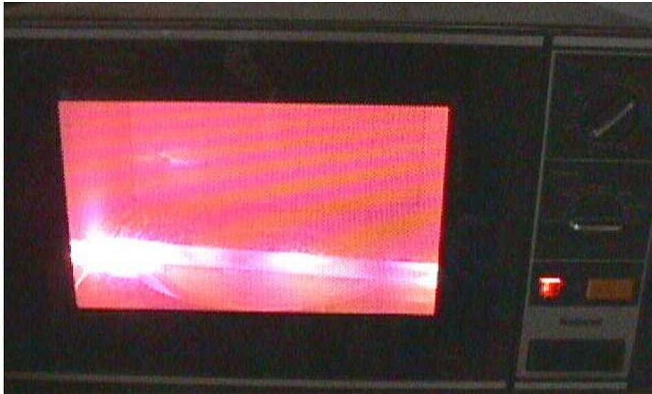
Foto 4. 9 Formação de estado de plasma no interior da ampola de vidro que está dentro de um forno de microondas ligado
