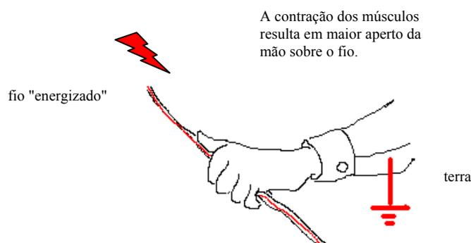
Figura 4. 4 Mão segurando um fio "energizado" sem isolamento elétrico
