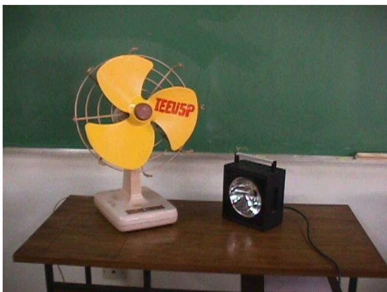
Foto 4. 7 Estroboscópio e ventilador para demonstração do efeito estroboscópico das lâmpadas de descarga gasosa
