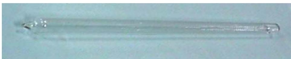
Foto 4. 8 Ampola de vidro *pirex* contendo vapor d'água a baixa pressão
