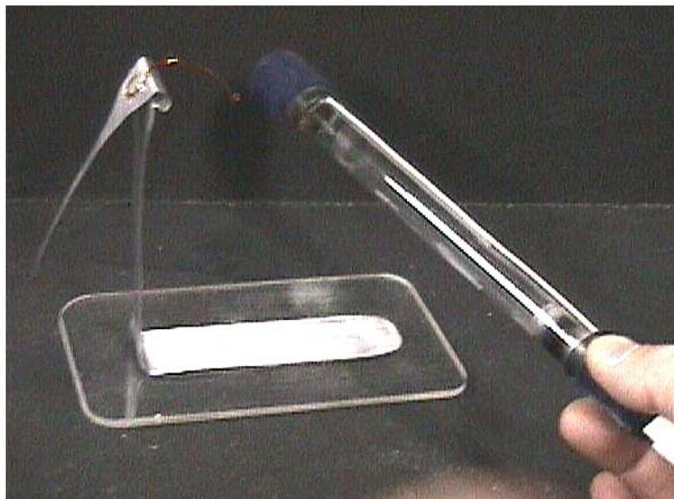
Foto 4. 6 A luz ultravioleta descarrega o eletroscópio quando ele está carregado com cargas negativas
