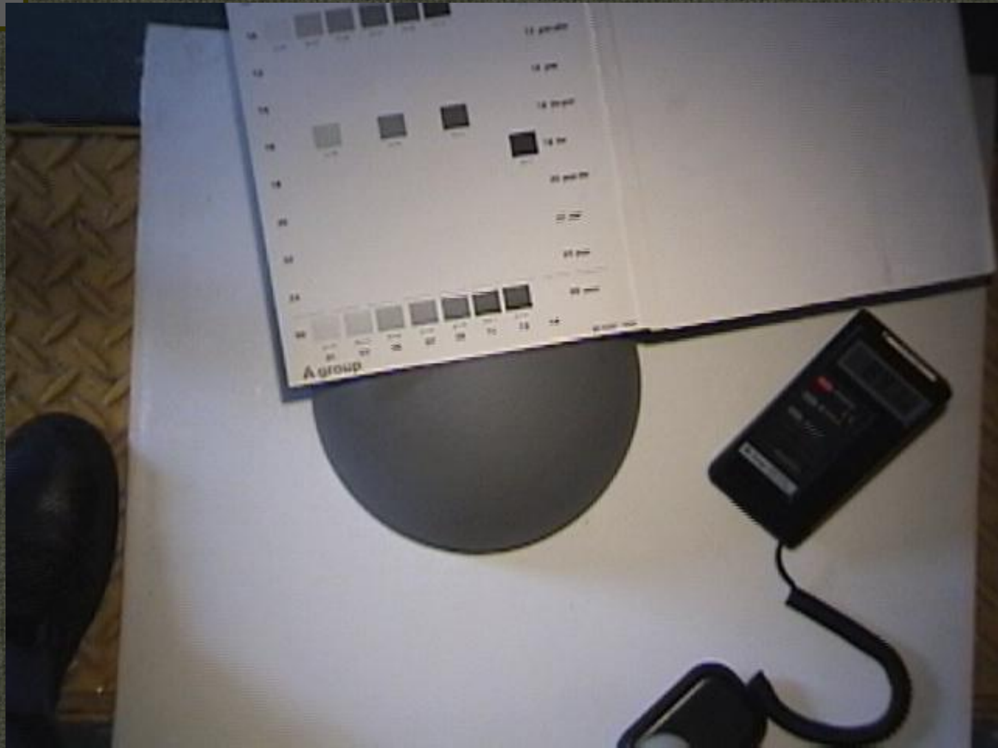
Figura – Foto do alvo utilizado no experimento, sobre superfície branca e ao lado uma escala referencial para a cor cinza neutra (norma inglesa BS 5252).
