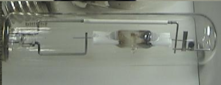
Figura – Detalhe do “queimador” de um tipo de lâmpadas a descarga em alta pressão (em inglês, HID).
