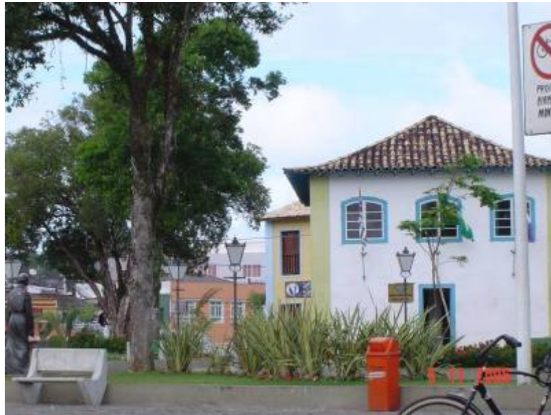
Figura 24: Foto de iluminação pública ornamental em praças com média densidade de vegetação, na qual são utilizadas luminárias abaixo da vegetação
