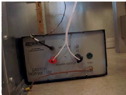
Figura 2 – LISN (Line impedance stabilization network) utilizada nas medições de IEM.
