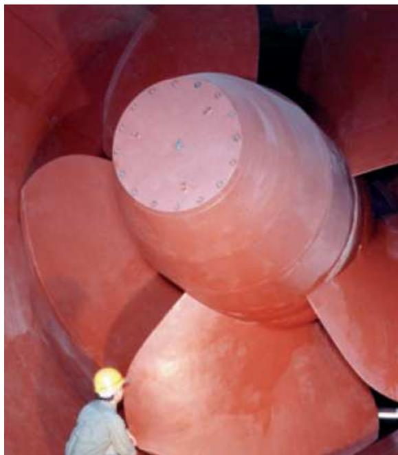
Figura 11 : Foto de um Rotor Bulbo.
