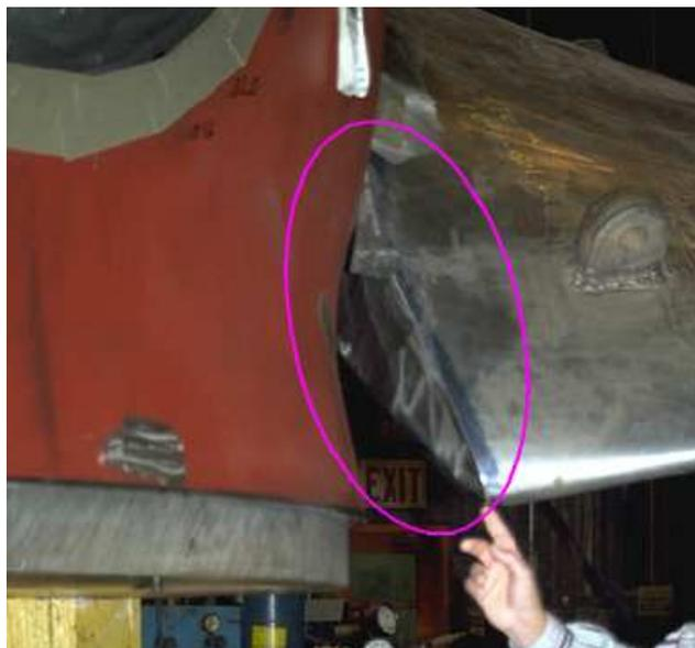
Figura 12 : Detalhe do vão entre pá e ogiva em Kaplan convencional, na posição aberta.
