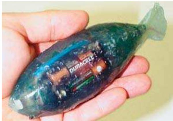
Figura 30 : O primeiro modelo de peixe falso desenvolvido pelo PNNL
