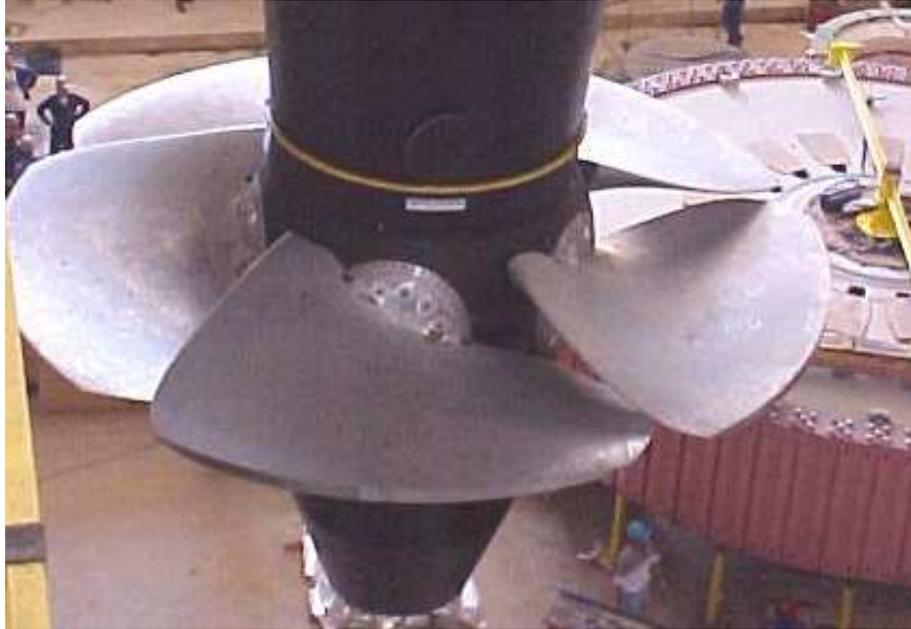
Figura 9 : Foto de um Rotor Kaplan.
