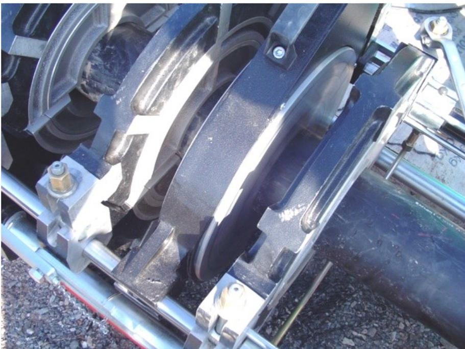
**Figura 47 Vista de faceamento de tubulação PEAD para soldagem**
