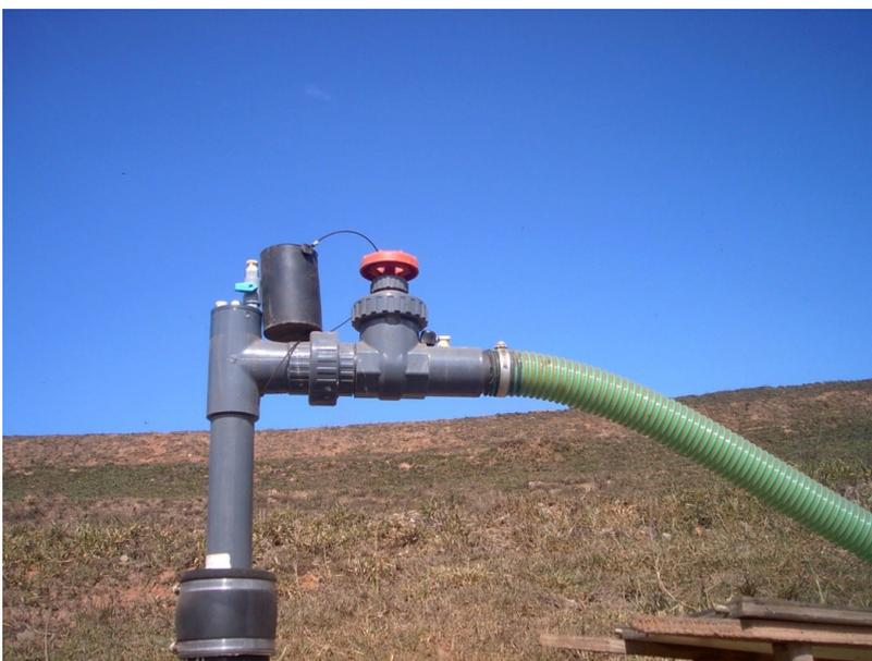
**Figura 79 Vista de cabeçote em teste no Aterro Sanitário LARA.**
