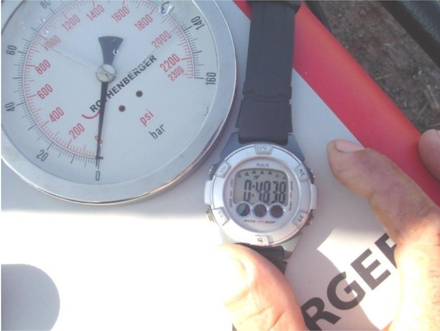
**Figura 48 Vista de verificação de tempo de aquecimento de solda topo**
