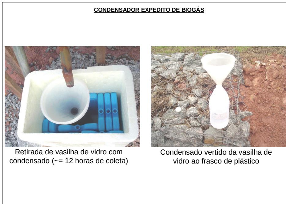
**Figura 30 Coleta de Condensado de Biogás do Condensador Expedito.**
