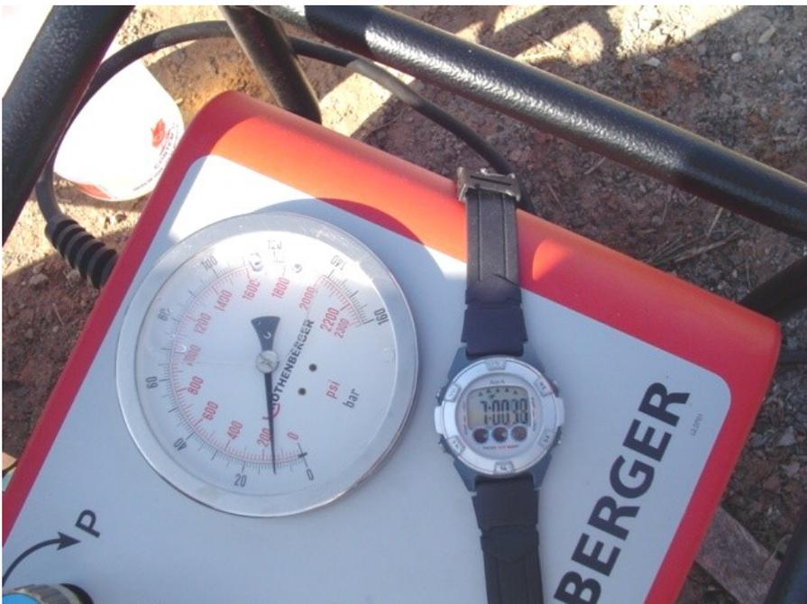
**Figura 49 Vista de verificação de tempo de resfriamento de solda topo**
