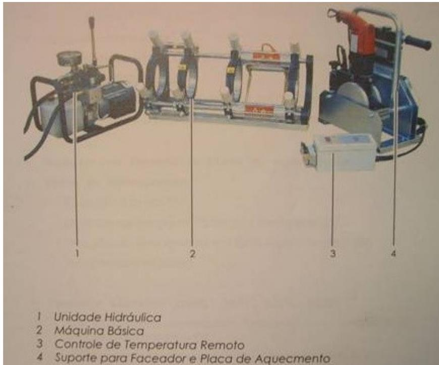
**Figura 45 Máquina de solda Topo KL 315**
