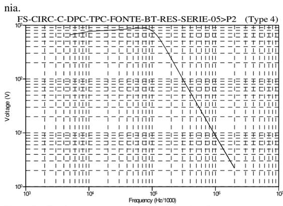
Figura 7 – Tensão de saída do circuito de ensaio (tensão aplicada sobre o DPC e TPC) com a inserção de resistência de 0,5Ω no lado de baixa tensão.
