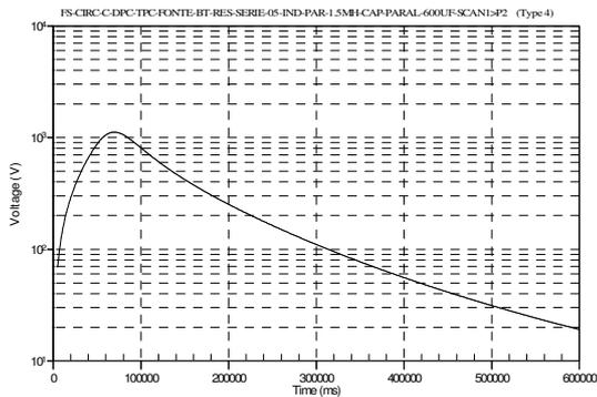
Figura 10 - Tensão de saída (no ponto de alimentação do DPC e TPC), com inserção no lado de baixa tensão, de resistência de  $0,5\Omega$  em série, e indutância de  $1,5\text{mH}$  e capacitância de  $600\mu\text{F}$  em paralelo.
