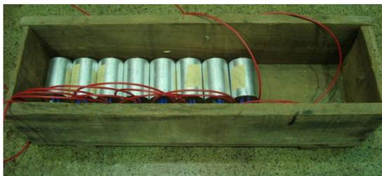
Figura 13 – Conjunto de capacitores utilizados para a compensação reativa, com tensão nominal 380VCA.
