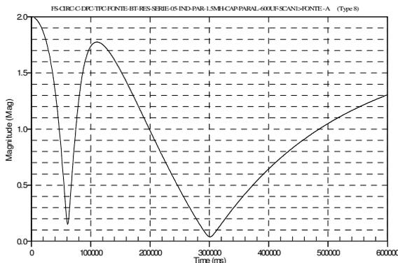
Figura 11 - Corrente exigida da fonte de tensão, com inserção no lado de baixa tensão, de resistência de  $0,5\Omega$  em série, e indutância de  $1,5\text{mH}$  e capacitância de  $600\mu\text{F}$  em paralelo
