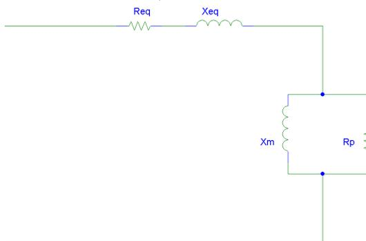
Figura 3 – Circuito equivalente do transformador elevador onde: Req – resistência equivalente, Xeq – reatância de dispersão, Xm – reatância de magnetização, Rp – resistência equivalente de perdas em vazio
