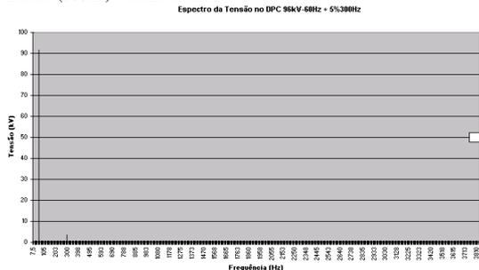
Figura 23 - Obtenção de alta tensão – 96kV em 60 Hz com 5% de 5ª harmônica (300Hz) – espectro
