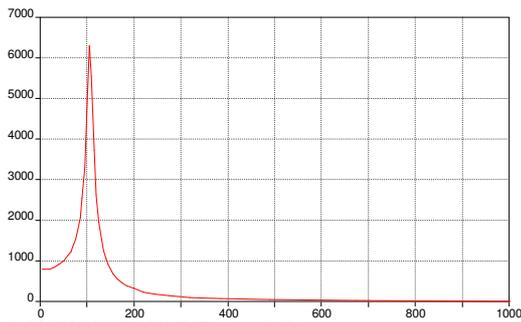
Figura 5 – Resposta em frequência do circuito representado na Figura 4.
