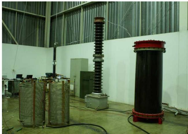
Figura 16 - Implementação do circuito de ensaio – transformador elevador (à esquerda), TPC (centro) e DPC (à direita), e indutores de 1mH para compensação reativa (em primeiro plano).
