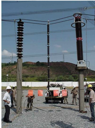
Figura 1 – Divisor de potencial capacitivo – medição em linha de transmissão de 345kv.
