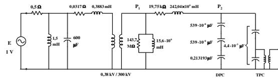
Figura 9 - Circuito de ensaio, com inserção no lado de baixa tensão, de resistência de 0,5Ω em série, e indutância de 1,5mH e capacitância de 600μF em paralelo.
